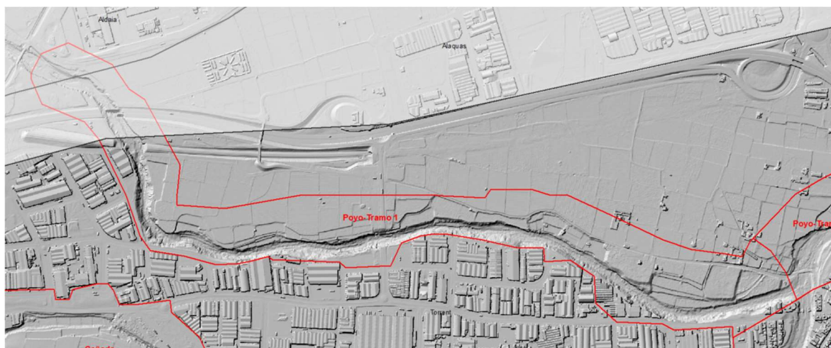
Figura 70. Rambla del Poyo. Tramo 1. Mapa de sombras a partir del Modelo Digital del Terreno (MDT) en la situación de Pre-DANA.
