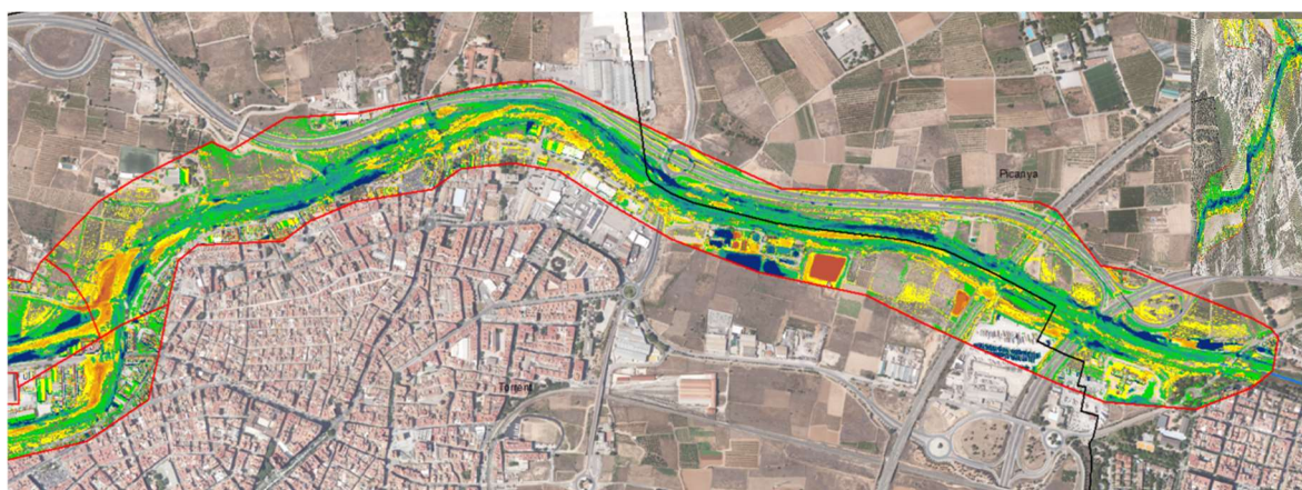
Figura 76. Rambla del Poyo. Tramo 2. Movimientos de tierras producidos por la DANA entre la situación anterior a la misma y la situación posterior.
