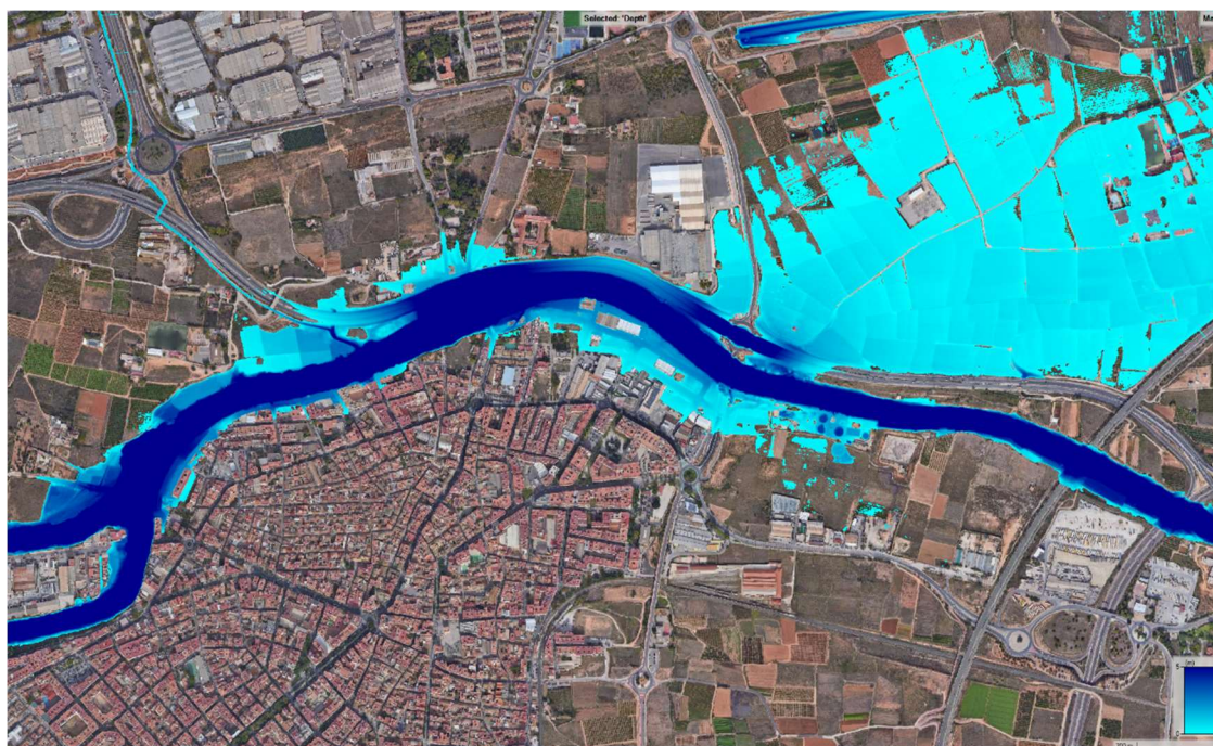
Figura 184. Resultados del modelo hidráulico en la zona 1 en la situación POST-DANA. T= 500 años.
