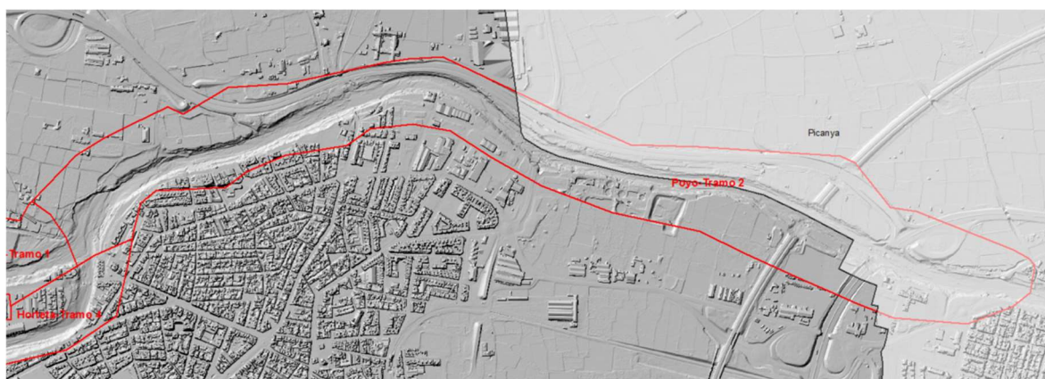
Figura 75. Rambla del Poyo. Tramo 2. Mapa de sombras a partir del Modelo Digital del Terreno (MDT) en la situación de Post-DANA.
