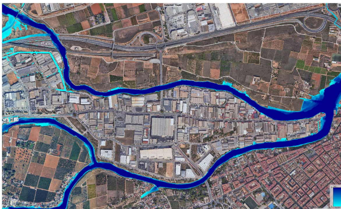
Figura 186. Resultados del modelo hidráulico en la zona 2 en la situación POST-DANA. T= 500 años.
