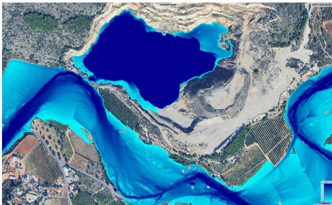
Figura 177. Resultados del modelo hidráulico en el entorno de la cantera de Calicanto, a las 18:30 h.
