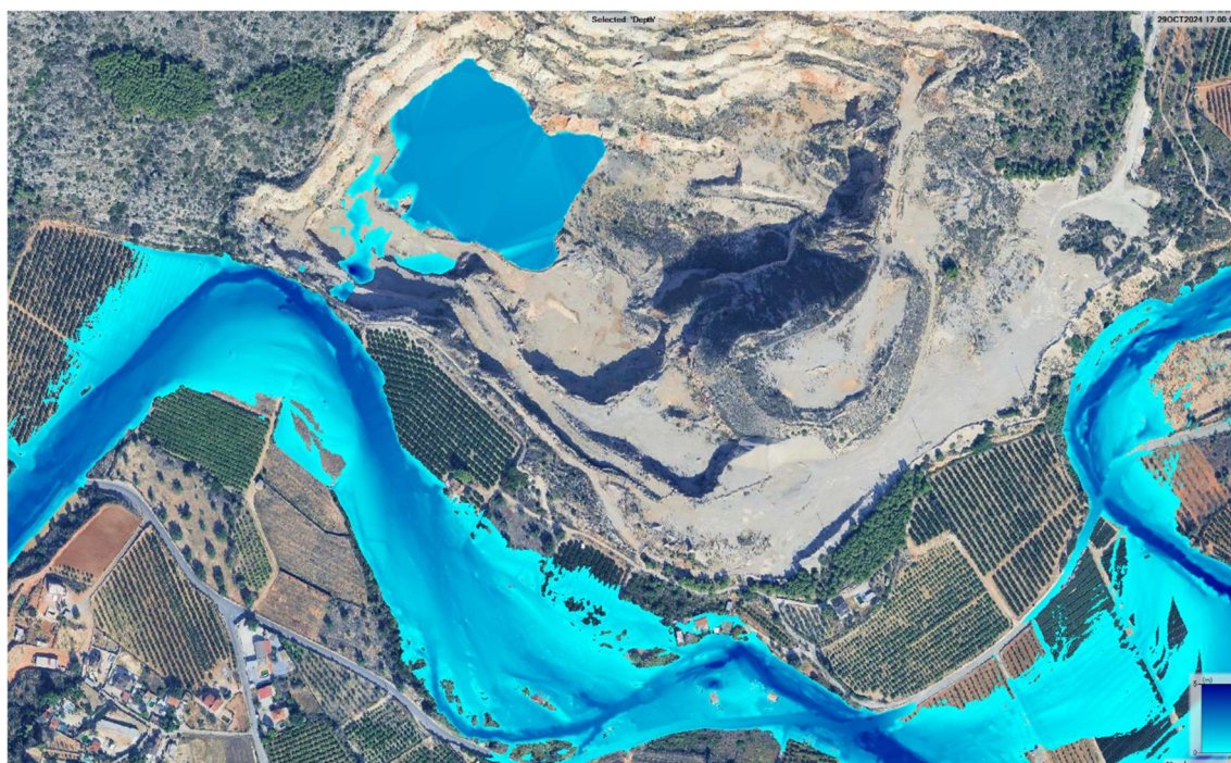
Figura 176. Resultados del modelo hidráulico en el entorno de la cantera de Calicanto, a las 17 h.
