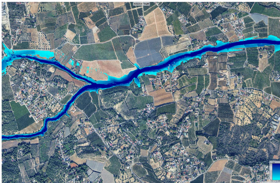
Figura 173. Resultados de modelación hidráulica de la inundación generada por la DANA. Envoltente de calados máximos en la zona 6 de Torrent.
