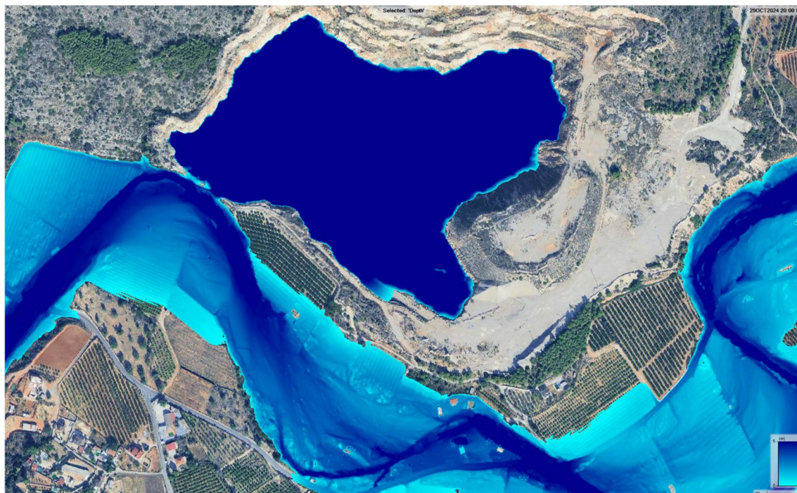
Figura 178. Resultados del modelo hidráulico en el entorno de la cantera de Calicanto, a las 20 h.
