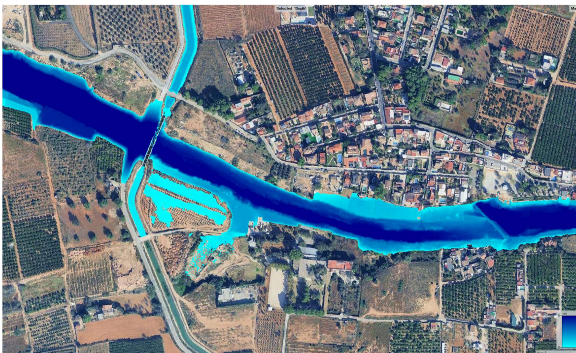
Figura 203. Detalle del Bco. de Horteta en la zona del pantano. Situación PRE-DANA. T= 500 años.
