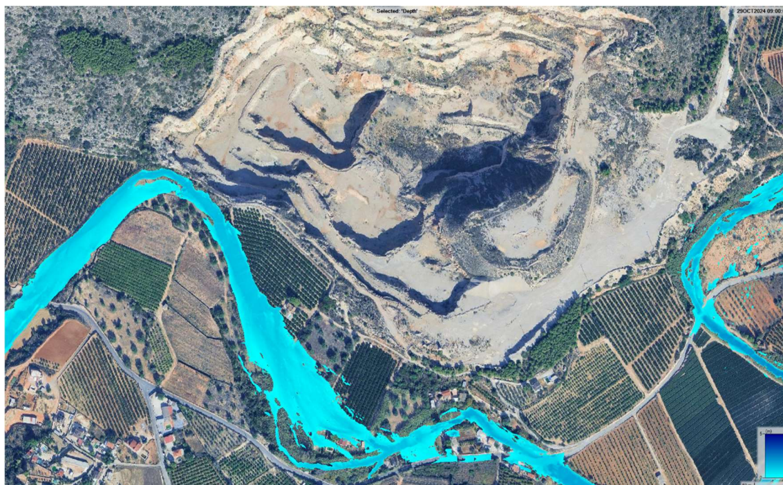
Figura 175. Resultados del modelo hidráulico en el entorno de la cantera de Calicanto, a las 9 h.
