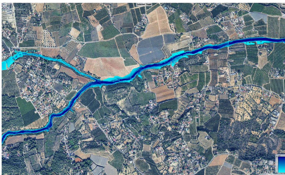
Figura 194. Resultados del modelo hidráulico en la zona 6 en la situación POST-DANA. T= 500 años.
