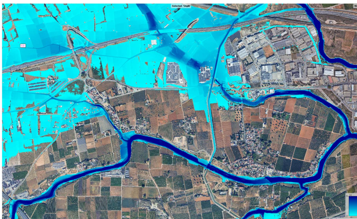
Figura 188. Resultados del modelo hidráulico en la zona 3 en la situación POST-DANA. T= 500 años.
