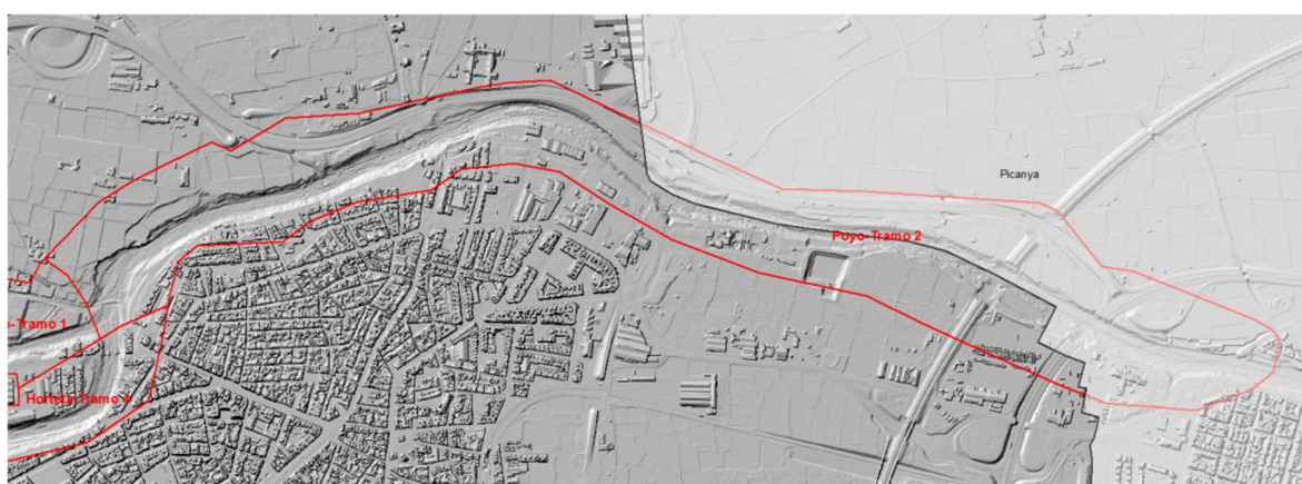
Figura 74. Rambla del Poyo. Tramo 2. Mapa de sombras a partir del Modelo Digital del Terreno (MDT) en la situación de Pre-DANA.
