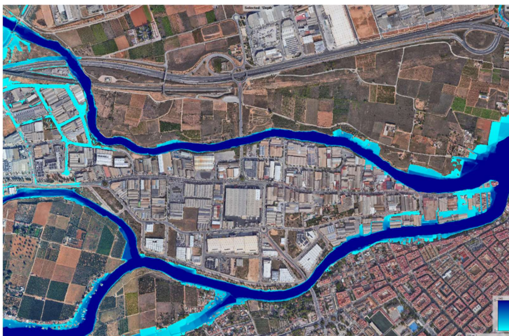
Figura 166. Resultados de modelación hidráulica de la inundación generada por la DANA. Envolvente de calados máximos en la zona 2 de Torrent.
