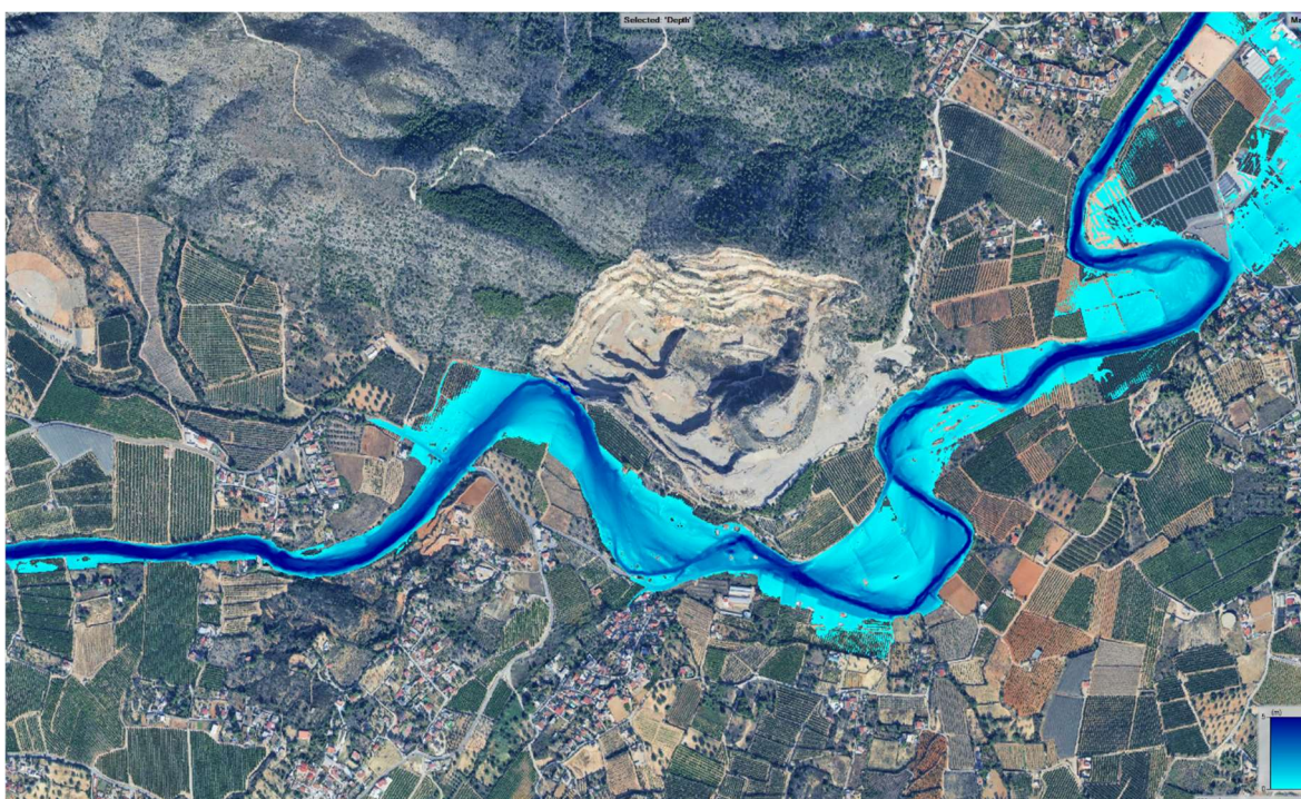
Figura 192. Resultados del modelo hidráulico en la zona 5 en la situación POST-DANA. T= 500 años.
