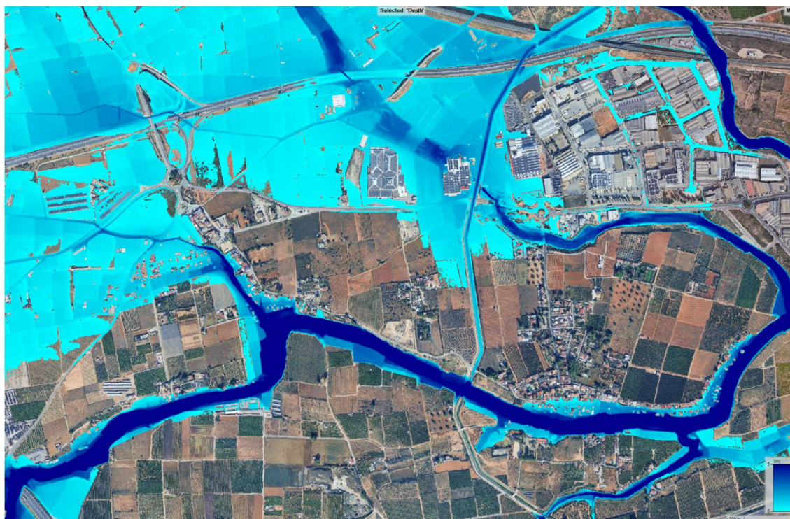
Figura 167. Resultados de modelación hidráulica de la inundación generada por la DANA. Envolvente de calados máximos en la zona 3 de Torrent.
