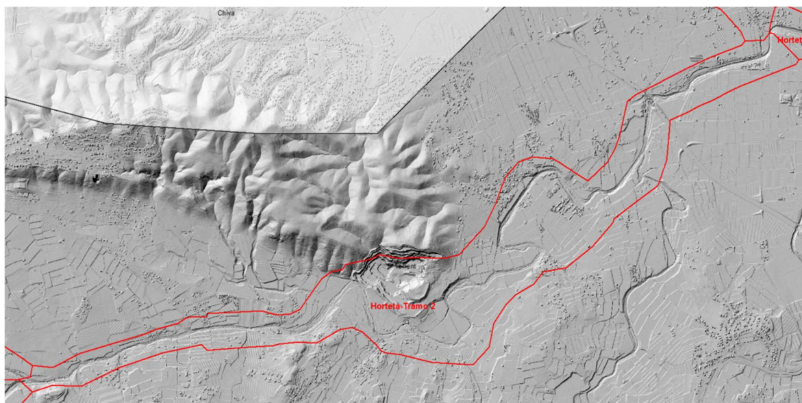
Figura 58. Barranco de Horteta. Tramo 2. Mapa de sombras a partir del Modelo Digital del Terreno (MDT) en la situación de Pre-DANA.
