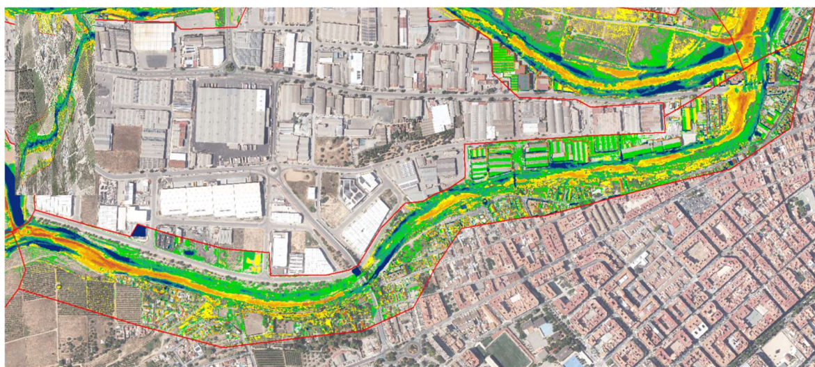
Figura 68. Barranco de Horteta. Tramo 4. Movimiento de tierras producidos por la DANA entre la situación anterior a la misma y la situación posterior.
