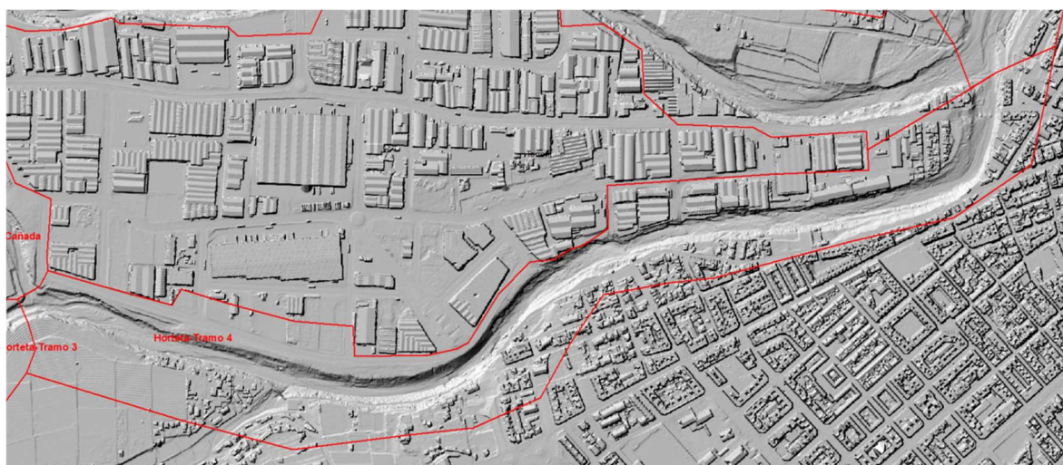
Figura 67. Barranco de Horteta. Tramo 4. Mapa de sombras a partir del Modelo Digital del Terreno (MDT) en la situación de Post-DANA.
