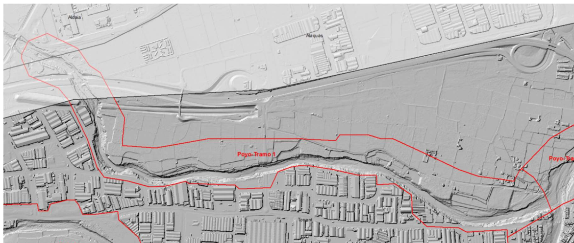
Figura 71. Rambla del Poyo. Tramo 1. Mapa de sombras a partir del Modelo Digital del Terreno (MDT) en la situación de Post-DANA.
